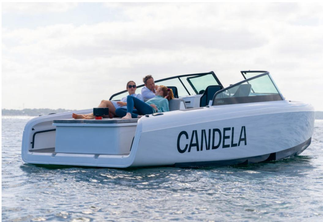
*Die Candela C-8 eröffnet neue Dimensionen für Reichweite und Geschwindigkeit bei Elektrobooten. Durch den cleveren Einsatz von computergesteuerten Hydrofoils wird der Energiebedarf im Vergleich zu konventionellen Sportbooten drastisch reduziert.*
