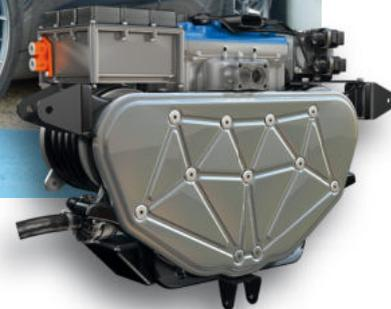
Prototypen auf Tesla-Basis mit negativen Emissionswerten bei Obrist in Lindau: Der kleine Zweizylinder-Motor (links) liefert mit klimaneutralem Methanol den Strom für den E-Motor (oben) im Heck. Die Reichweite liegt bei rund 1000 Kilometern.
